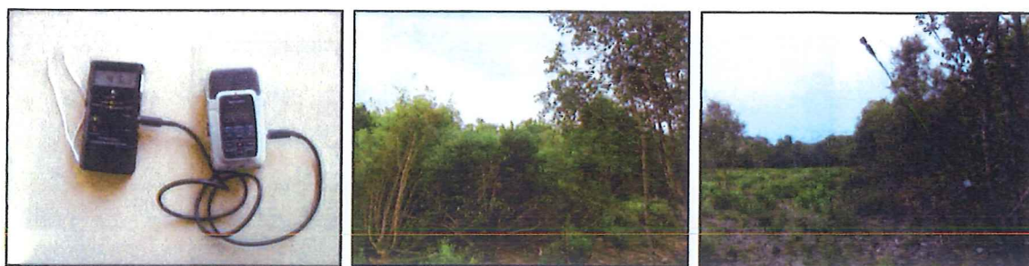
PETTERSSON D240X couplé à un enregistreur numérique (gauche), et installation des micros et du SM2 BAT™ (centre, droite)
